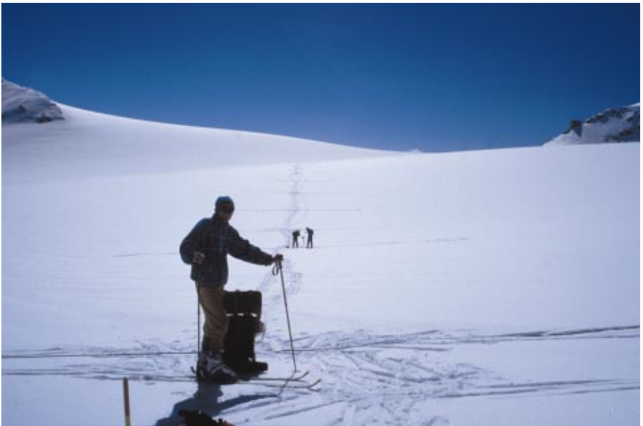
Abb. 3: Radio-Echolotung der Eisdicke am Kesselwandferner in ca. 3200 m Höhe.
