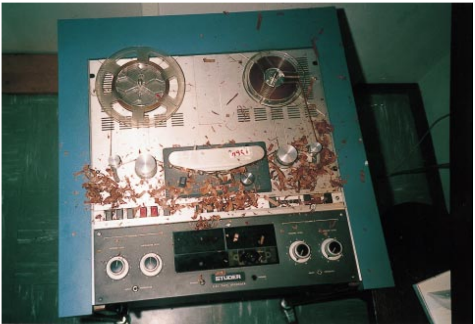
Abb. 2: Totalverlust der informationstragenden Schicht eines Magnetbandes. Produktionsfehler oder unentrinnbares Schicksal jedes Magnetbandes? EUREKA-Projekt EUROCARE EU 892 AVIDA. Projektpartner: Österreichisches Kunststoffinstitut.
