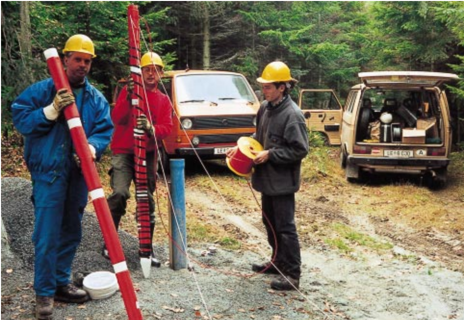
Abb. 1: Tiefenreflexionsseismik. Vorbereiten der Sprengladungen zum Einführen in die Schußbohrung.
