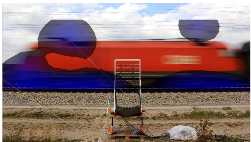
Abbildung 1.11: Schallamplitude am Kopf im tiefen Frequenzbereich und schematische Darstellung der Schalldetektion mittels Mikrophonarrays
