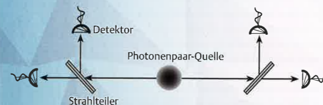
John Clausers Experiment zum Nachweis von Einzelphotonen. (Quelle: Autoren)
