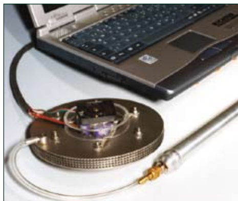
Eine kleine Brennstoffzelle betreibt einen Laptop. Der dünne Zylinder enthält den Wasserstoff.
